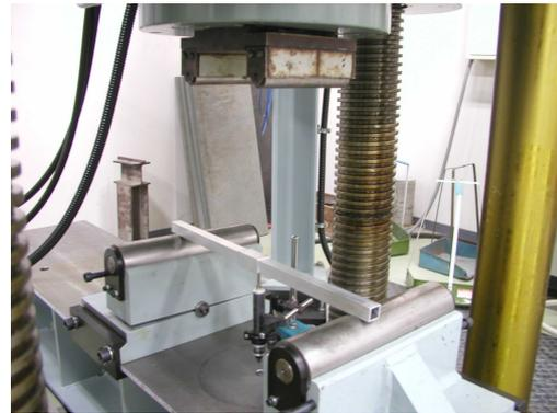
図3 曲げ実験に用いた万能試験機
