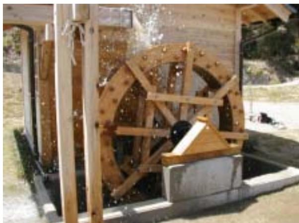
写真-9 高流量時の水の跳ね飛び
