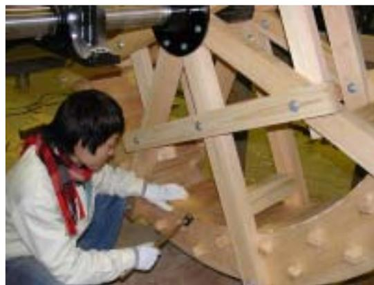
写真-5 羽根車の組立て状況
