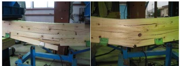
図 7 破壊性状
